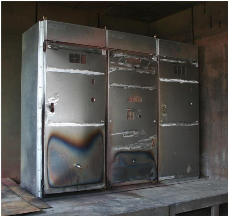
Вид ячеек после двух испытаний. Ни одна из дверей не открылась, корпус ячеек не разрушился
