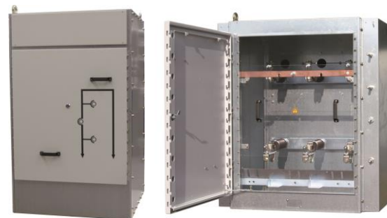
РУВН с воздушной изоляцией типа MSA-L до 24 кВ компактная измерительная ячейка и ячейка предохранительная
